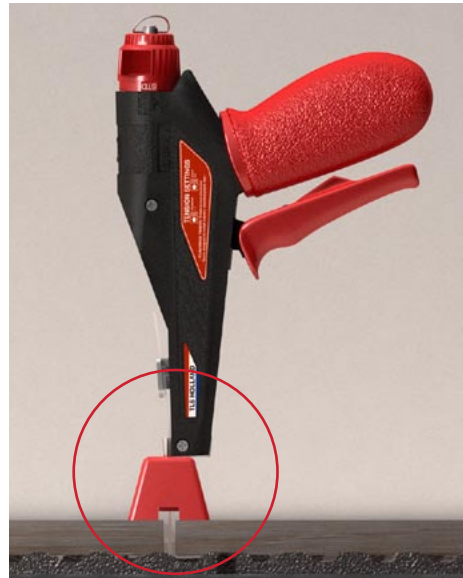
Afb. 5d Aantrekken totdat de tegels gelijk liggen
